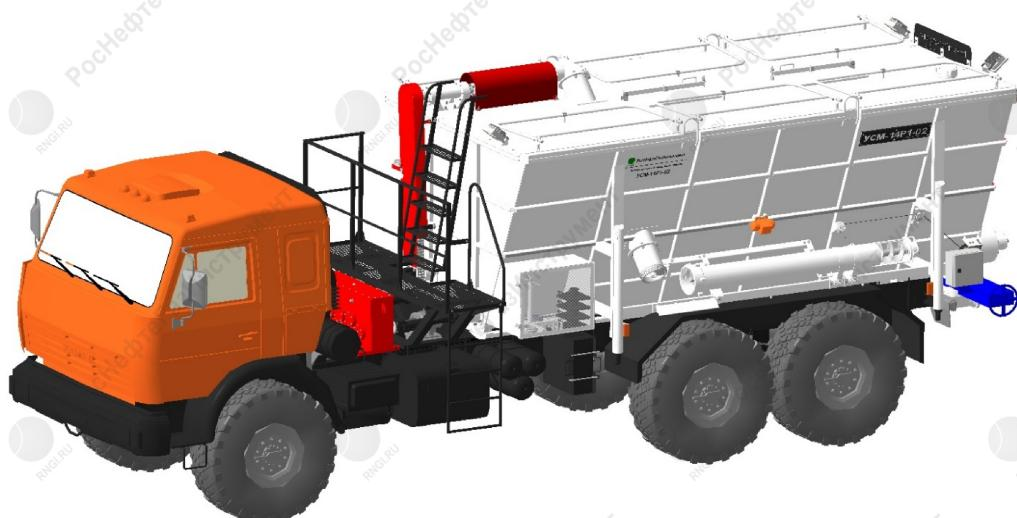
Рис. 7 - Установка смесительная механическая УСМ-14Р1-02 в транспортном положении.
