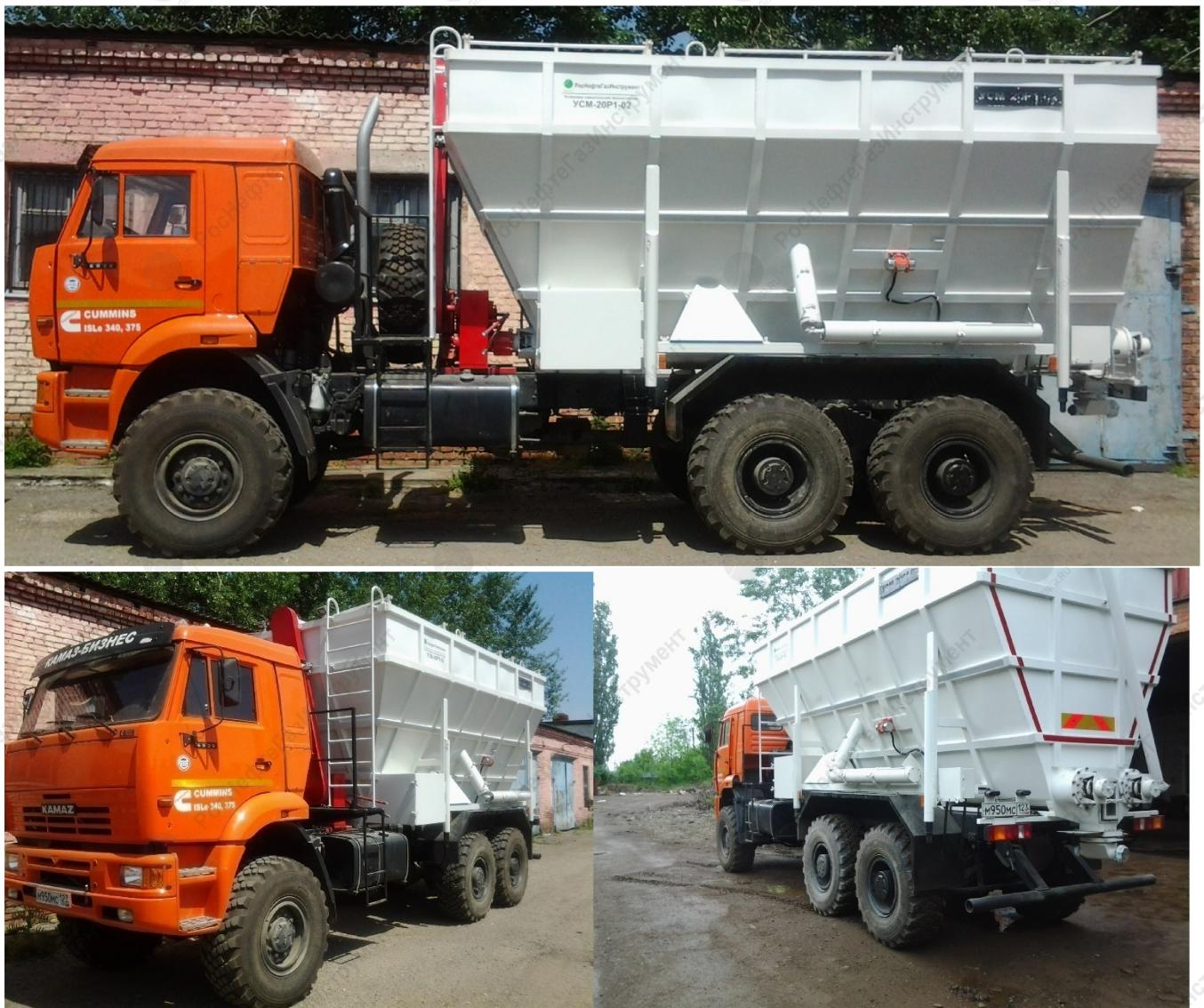
Рис. 10 – УСМ-20Р1-02 на шасси КАМАЗ 6522.
